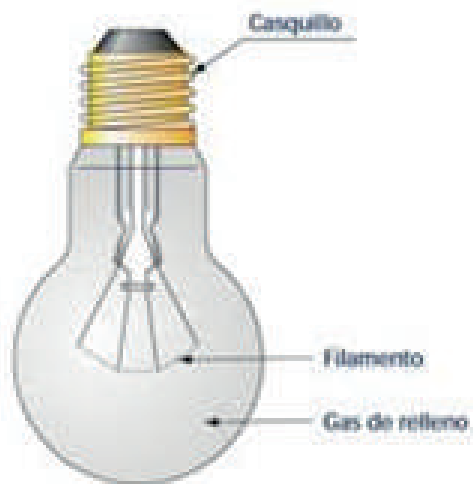
Fig. 18 Partes de una bombilla. (Iluminación en interiorismo, 2012)
