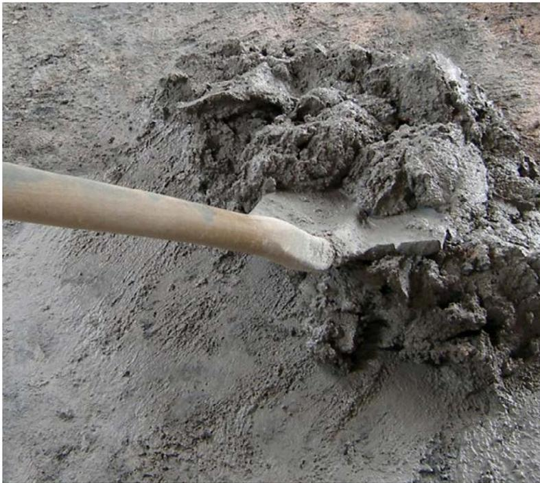
Figura 6: mezcla tierra- cemento.
