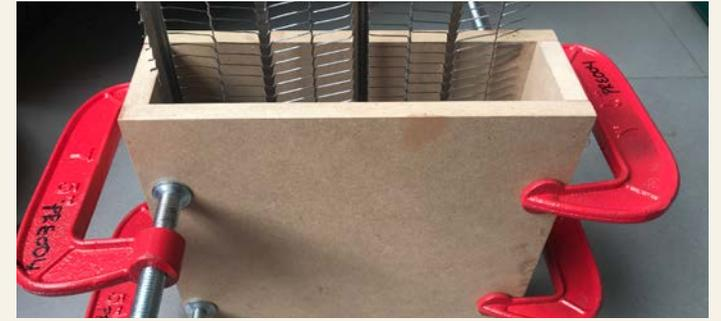
Figura 24: Encofrado grande
