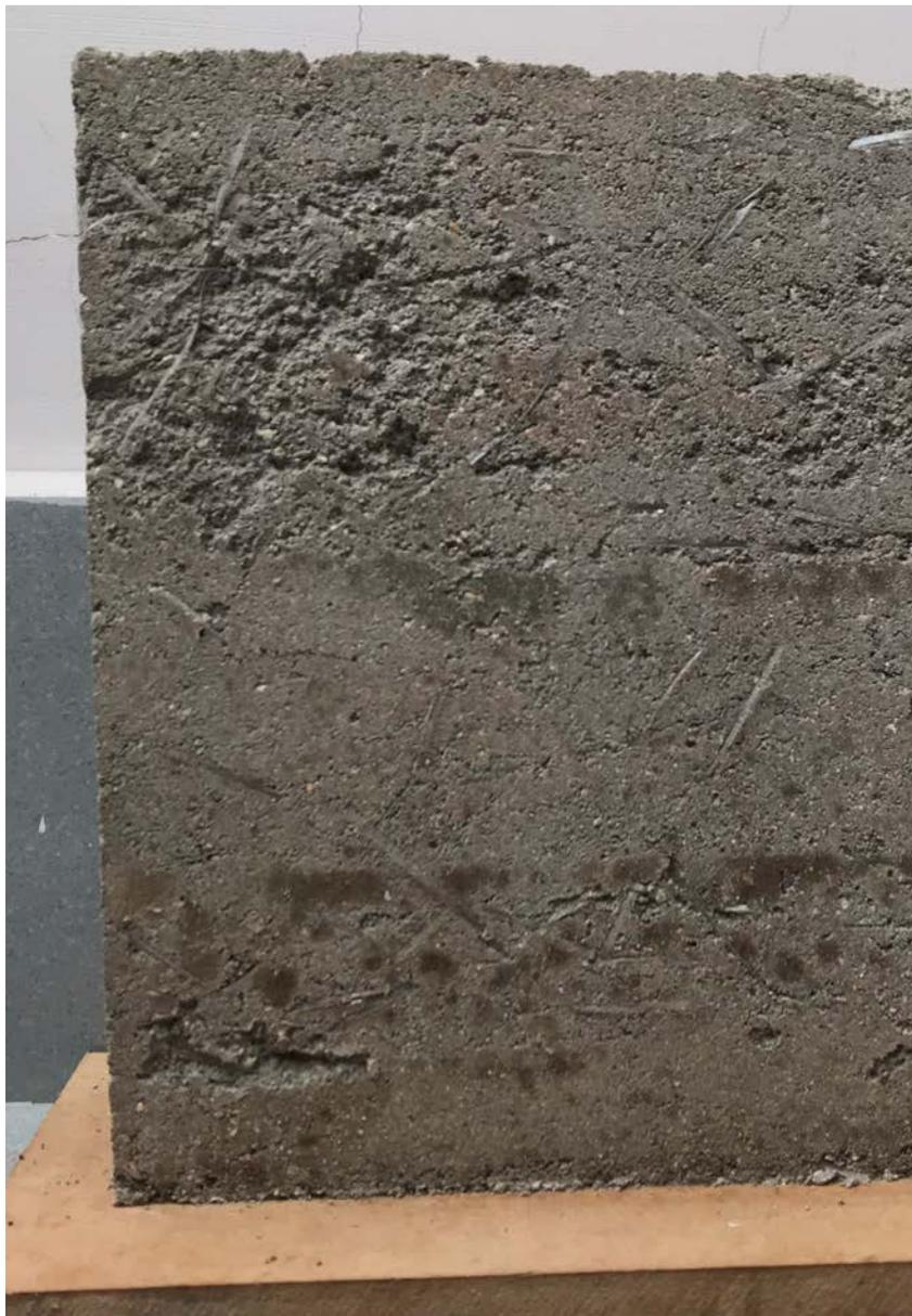
Figura 22: Resultado con la arcilla blanca y con la fibra sintética
