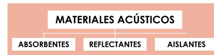
Ilustración 10. Clasificación de materiales acústicos. Manual de acústica ambiental y arquitectónica. 2017
