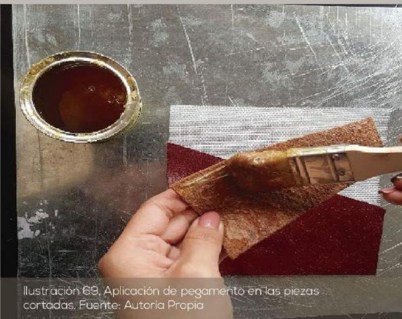
Ilustración 69, Aplicación de pegamento en las piezas cortadas. Fuente: Autoría Propia
