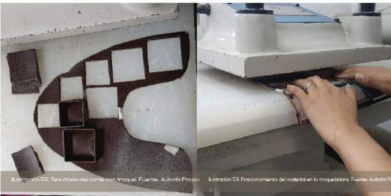
Ilustración 59. Resultado del corte con troquel. Fuente: Autoría Propia
