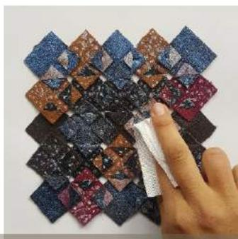
Ilustración 100, Frote con tela testigo seca. Fuente: Autoría Propia
