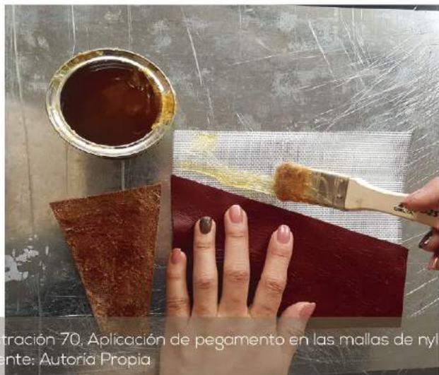
Ilustración 70, Aplicación de pegamento en las mallas de nylon. Fuente: Autoría Propia
