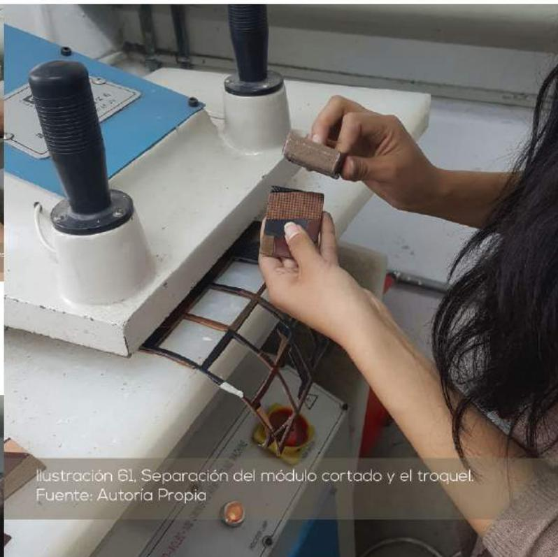
Ilustración 61. Separación del módulo cortado y el troquel. Fuente: Autoría Propia
