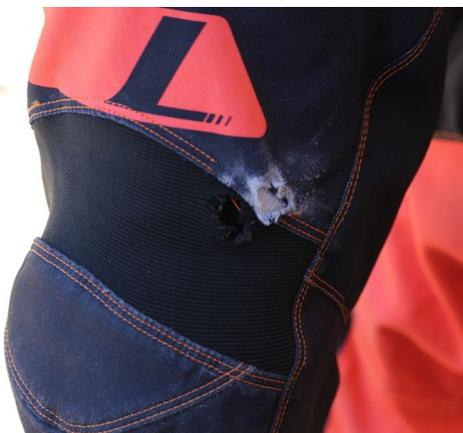
Figura 42. Desgaste del textil en la rodilla (Autoría propia, 2019)
