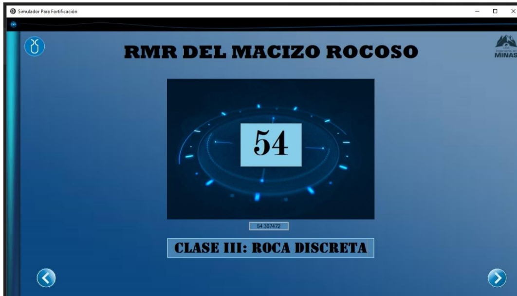
Figura 2.15 Ventana RMR del macizo rocoso. Fuente: Los Autores.
