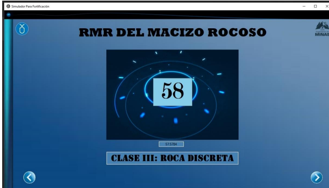
Figura 3.1 Valor RMR del Tramo 6 obtenido en la aplicación. Fuente: Los Autores.
