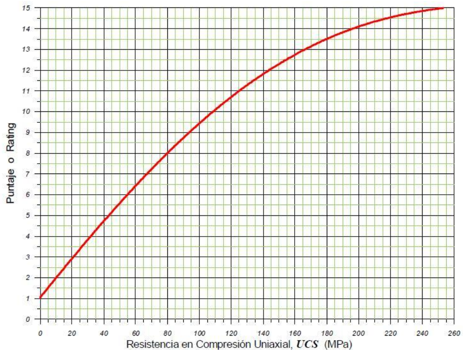
Figura 1.9. Curva de determinación del puntaje por Resistencia a la Compresión Uniaxial. Fuente: (E.T.S.E.C.C.P.B. - U.P.C.).
