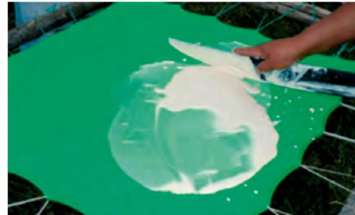
Figura 22. Encauchado de fibras textiles, (Cedillo,M, y Pérez,C, 2012).
