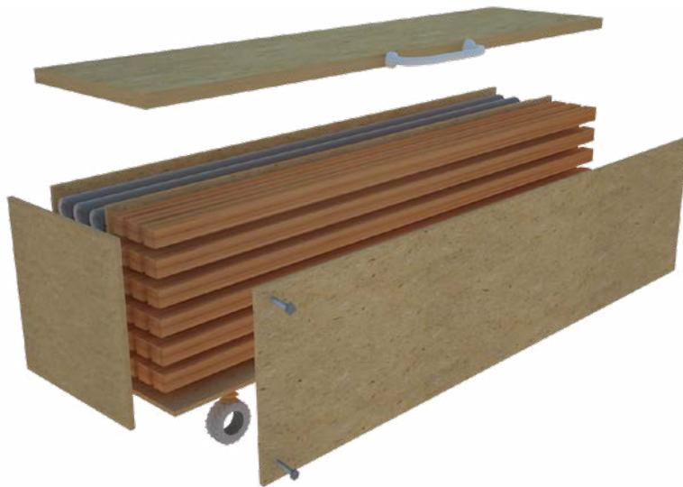
Ilustración 73. Caja aglomerada para tubos y listones de madera 1.
