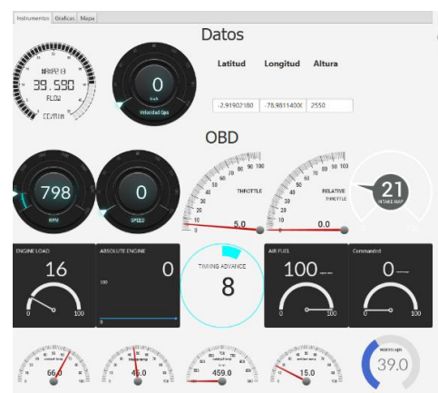
Fig. 8. Interfaz gráfica durante la prueba de dinamómetro.
