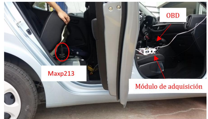
Fig. 13. Sistema conectado al vehículo
