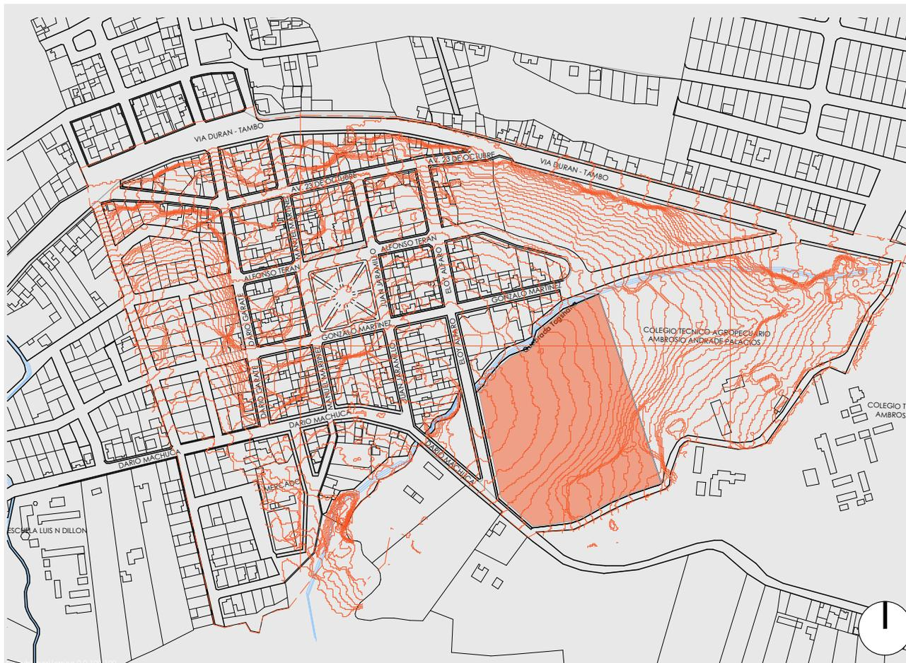
El sitio de emplazamiento del proyecto se realiza en una topografía con pendiente uniforme, de esta manera la construcción del proyecto se lo plantea a través de terrazas a distintos niveles.
