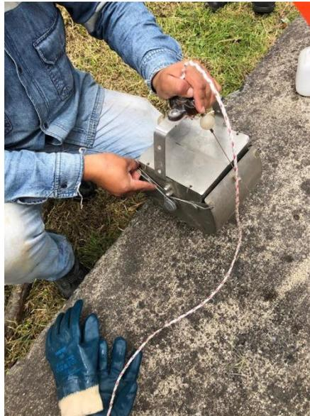
Figura 2. 6 Preparación de la almeja de lodos.
