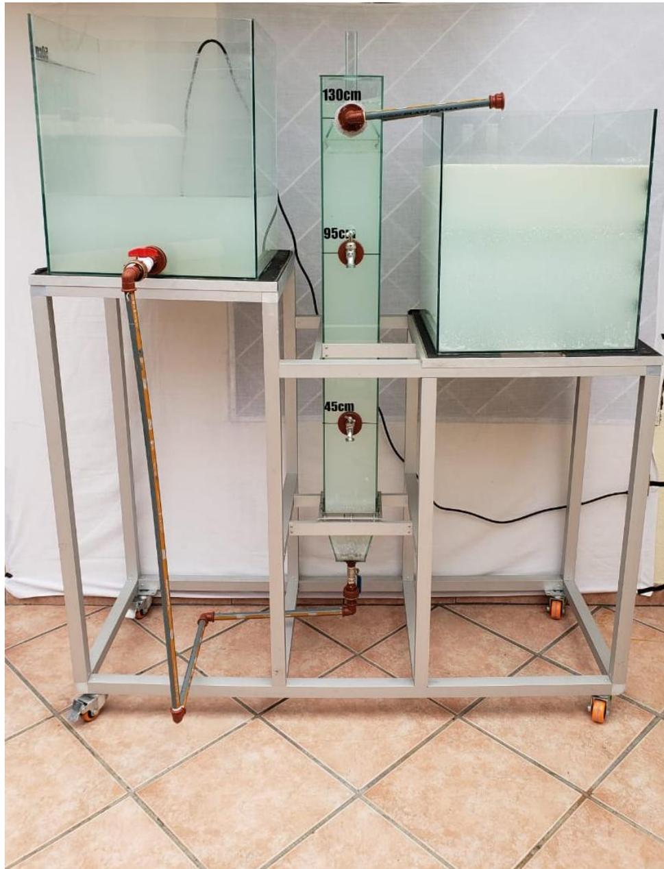
Figura 3-1. Digestor anaerobio.
