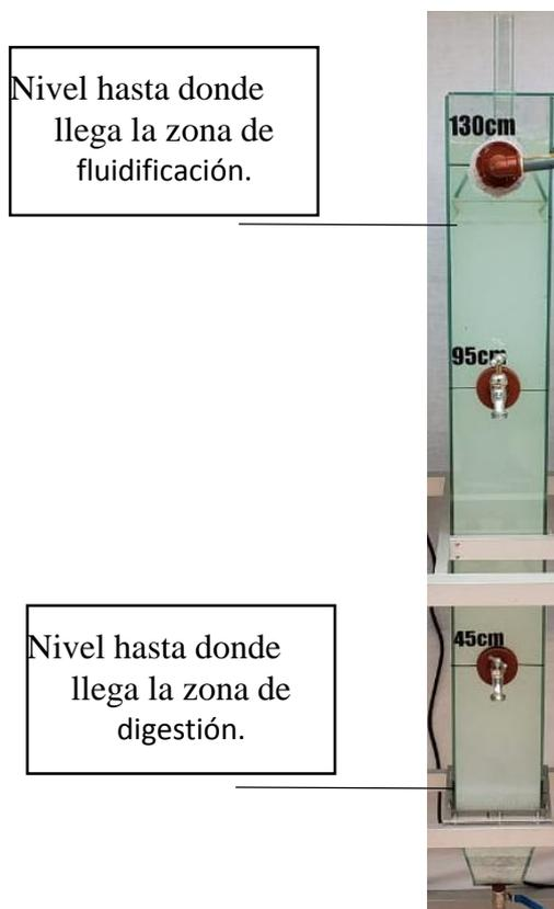
Figura 3-7. Identificación de las zonas del reactor en el modelo real.
