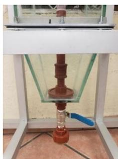
Figura 3-15. Llave de paso del reactor.
