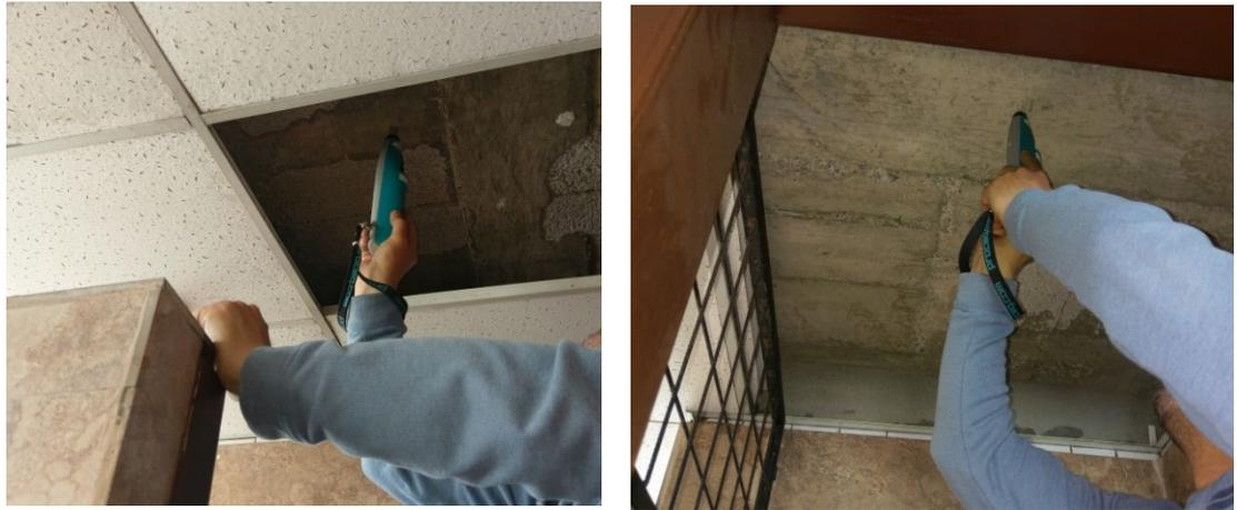
*Figura 11. Detección de resistencia del hormigón*
