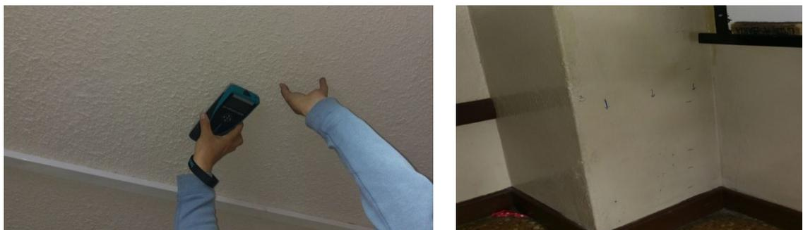
*Figura 12. Detección de armaduras*
