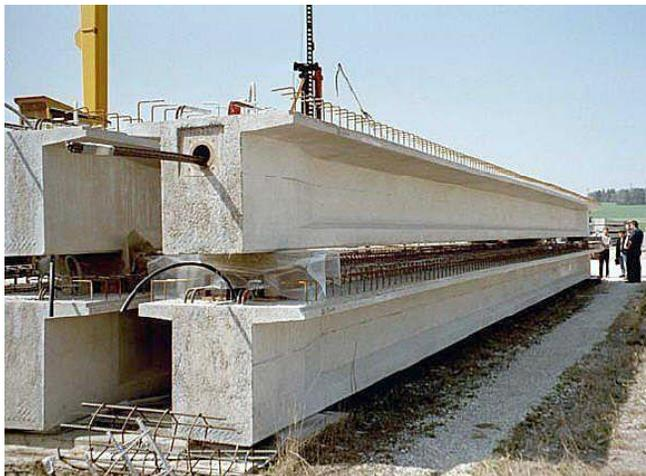
**Figura 23 Elementos de hormigón pretensado.**
