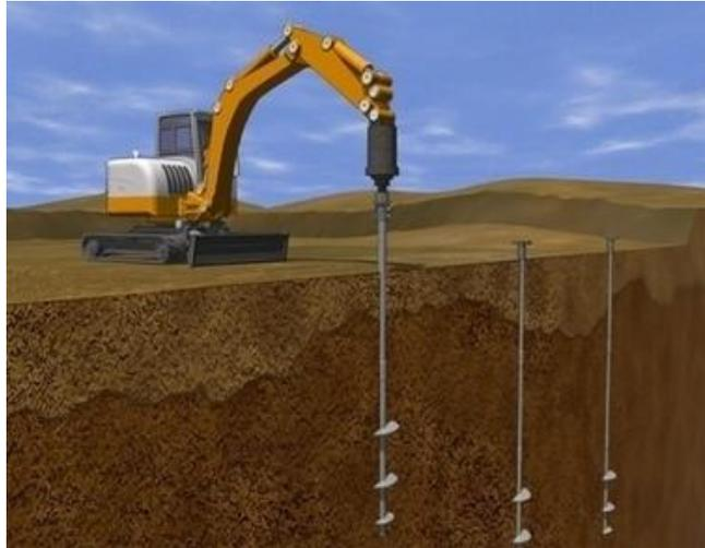
**Figura 43 Cimentación profunda tipo pilote.**
