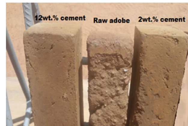
Figura 03. Muestras de adobe con agregado de cemento Fuente: Dao et.al, 2018
