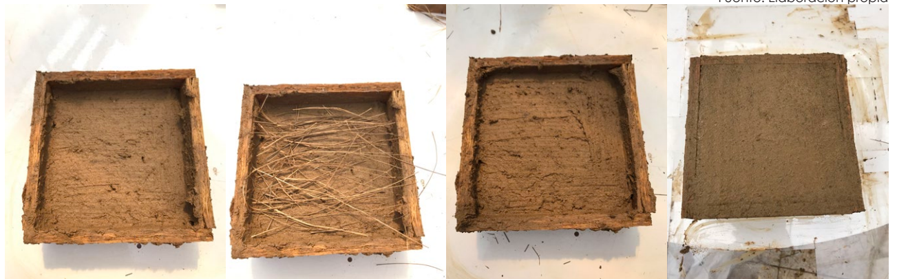
Figura 33. Capa 1 de barro, figura 34. capa 1 de paja, figura 35. capa 2 de barro, figura 36 muestra final de empañete Fuente: Elaboración propia
