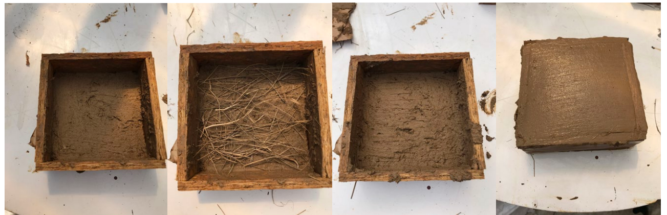
Figura 29. Capa 1 de barro, figura 30. capa 1 de paja, figura 31. capa 2 de barro, figura 32. muestra final de revoque Fuente: Elaboración propia
