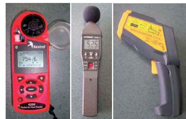
Figura 04-06. Herramientas de medición de temperatura, humedad y sonido Fuente: Vacacela, 2017
