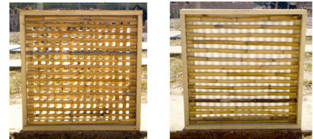
Figura 08. Muestras de quincha con y sin aislamiento Fuente: Cuitiño, 2015
