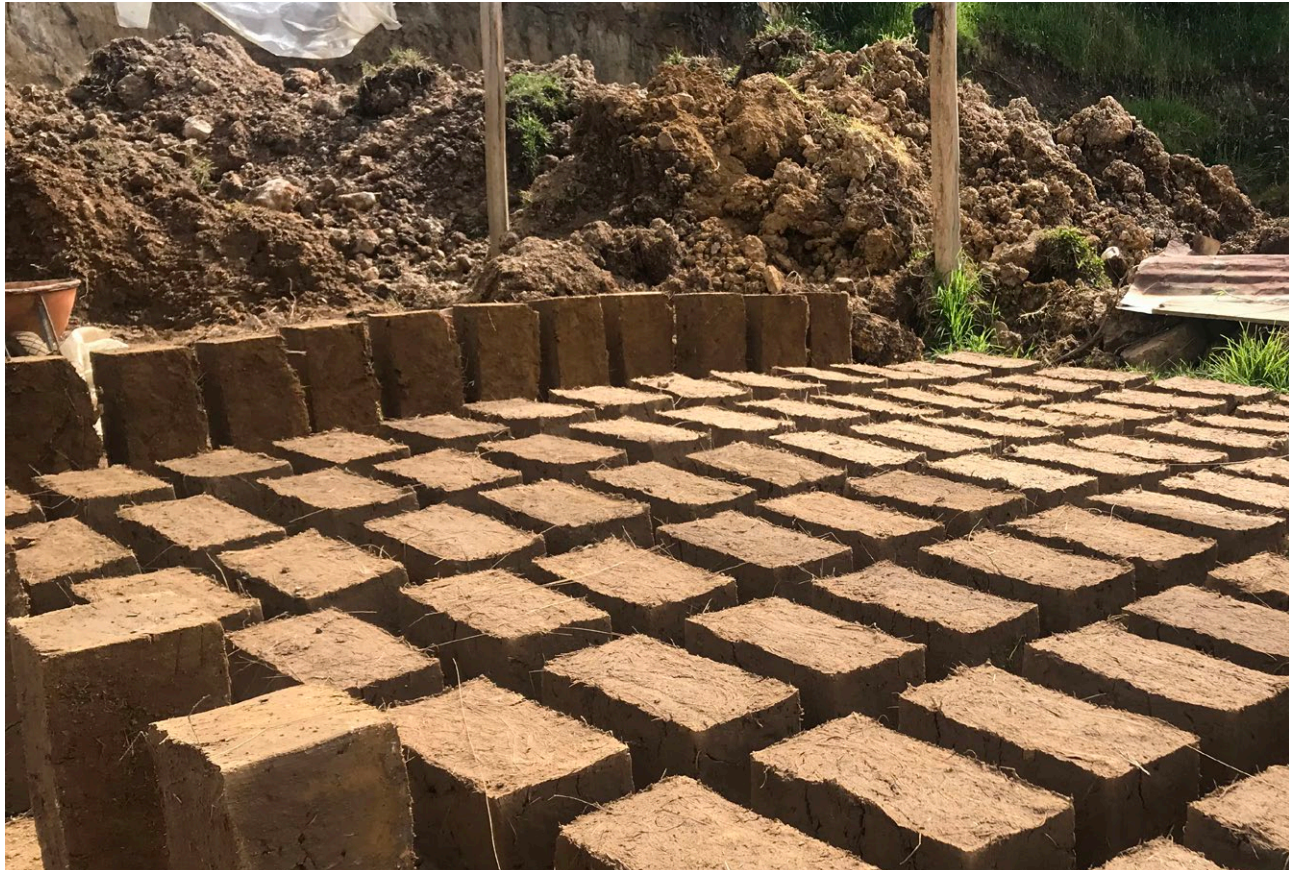
Figura 19. Adobe desmoldado Fuente: Propia
