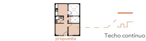
El techo continuo existente permite la modificación de las divisiones interiores de la vivienda, a excepción del patio y el dormitorio secundario que utiliza otro tratamiento en su cubierta.
