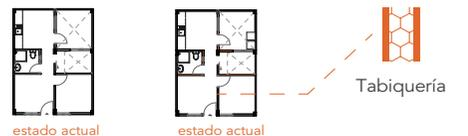
Se propone utilizar muros de junta seca para las paredes interiores, de tal manera que puedan ser desmontados fácilmente y permitan generar cambios en el programa original de la vivienda.
