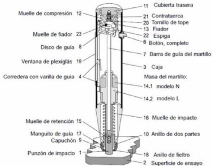
Figura 1.1. Sección longitudinal a través del martillo mostrando sus componentes
