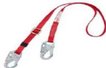
Las eslingas de posicionamiento pueden ser fabricadas en reata resistente a la fuerza, la abrasión y el envejecimiento, con resistencia de 5.000 libras (2.272 kg) y con terminaciones cosidas en su unión con los ganchos; estas, en lugar de tener guardacabos, deberán contar con un refuerzo de reata cosida para evitar desgaste de la eslinga en su rozamiento con los ganchos.
