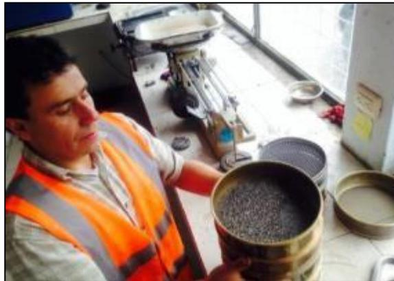
Ilustración 25. Pruebas Granulométricas.
