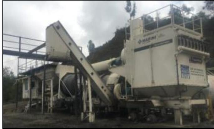
Ilustración 24. Sistema de filtros de mangas y sistema de elevación vertical.
