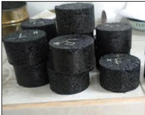
Ilustración 26. Ensayo de Briquetas.
