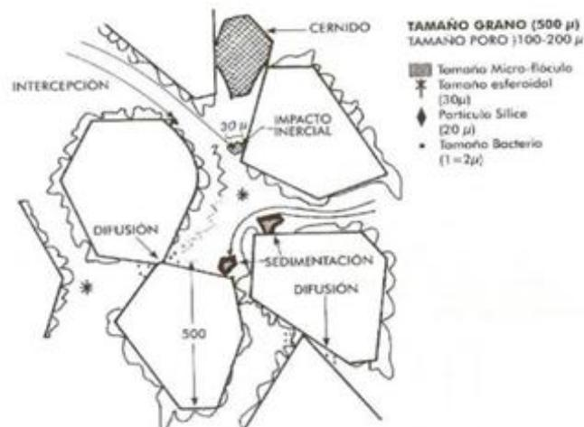
Figura 1.2 Interacción de los diferentes mecanismos de filtración por transporte de partículas
