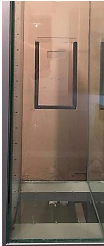
Figura 2.25 Sello para medir las diferentes alturas en la columna de filtración
