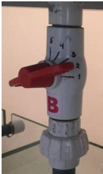
Figura 3.13 Válvula de esfera B en la posición 2
