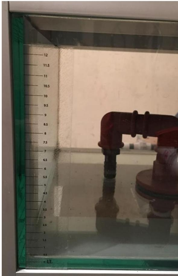
Figura 2.31 Sello para medir el volumen de agua tratada en el tanque de falso fondo
