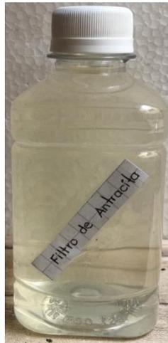
Figura 3.14 Muestra de agua turbia sintética a la salida del filtro de antracita
