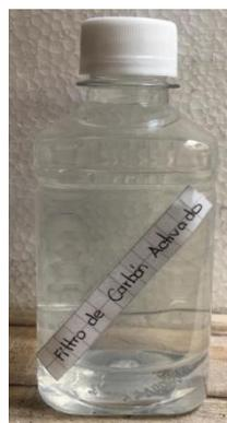
Figura 3.16 Muestra de agua turbia sintética a la salida del filtro de carbón activado
