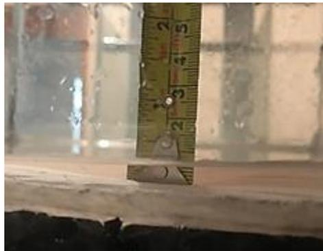
Figura 3.11 Nivel de agua que se forma sobre la capa filtrante
