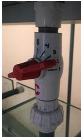
Figura 3.15 Válvula de esfera C en la posición 2
