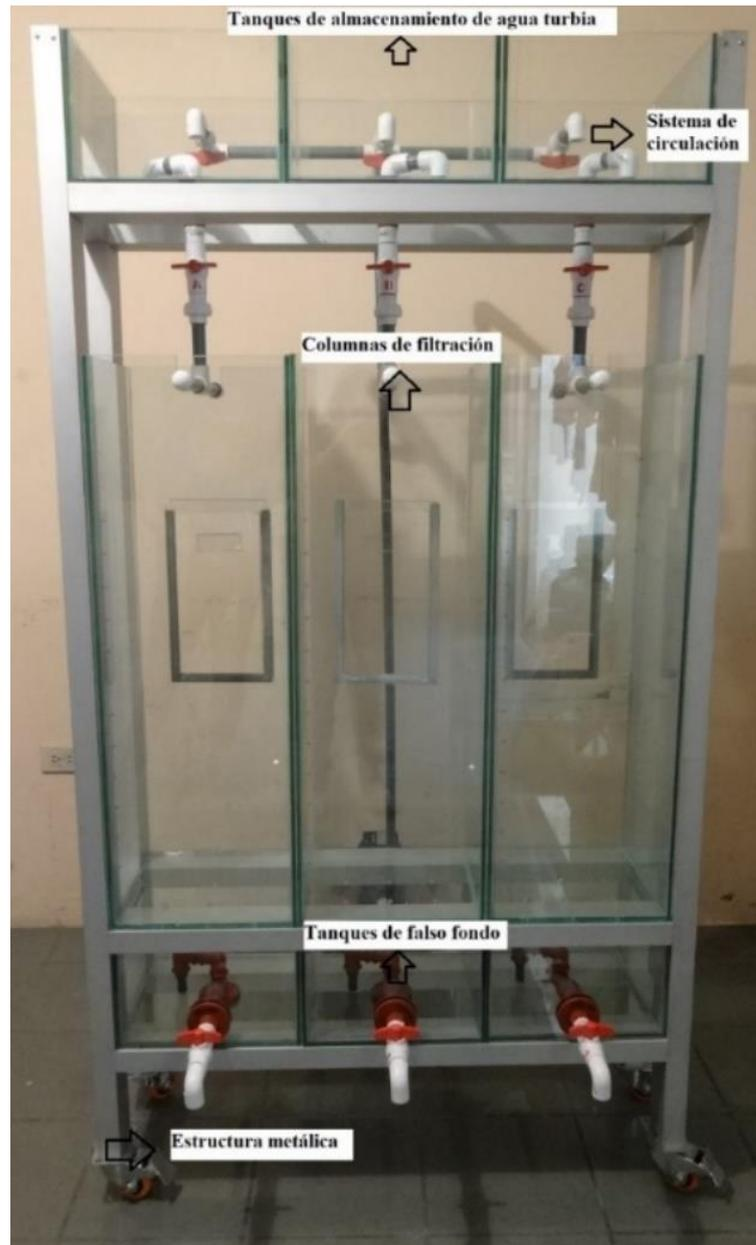
Figura 2.7 Modelo físico definitivo con sus principales partes
