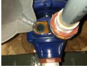
Figura 3.17 Colocación de agua en la bomba
