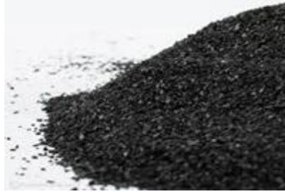
Figura 1.14 Carbón activado para filtros de agua
