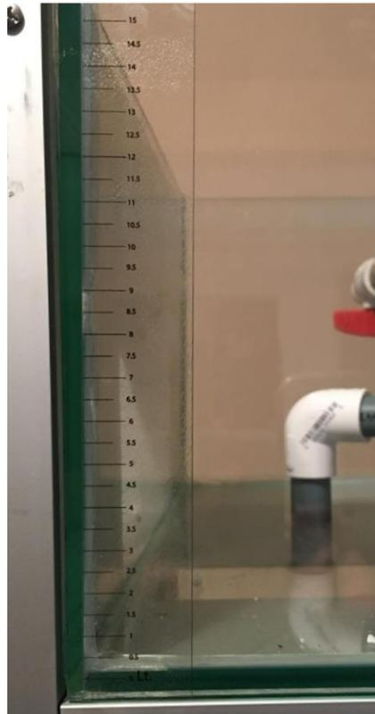
Figura 2.17 Sello para medir el volumen en el tanque de almacenamiento de agua turbia
