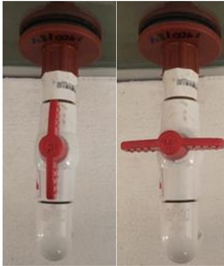
a) Válvula de esfera abierta. b) Válvula de esfera cerrada.
