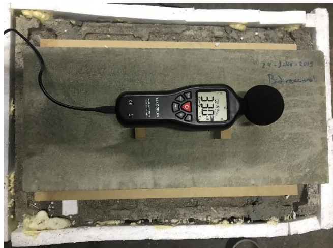
Figura 4-9 Prueba acústica, sonómetro exterior Fuente: Autores
