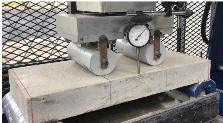
Figura 4-26 Ensayo a flexión de la losa bidireccional Fuente: Autores
