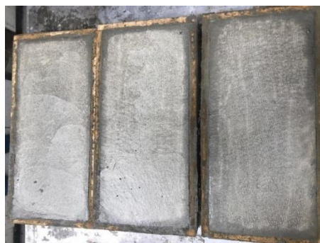
Figura 3-66 Losas finales después de la fundición Fuente: Autores
