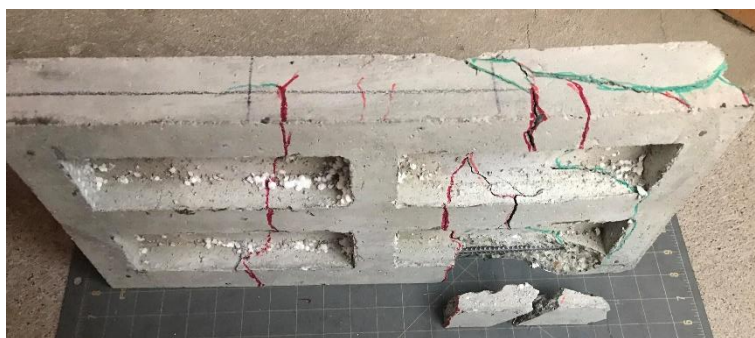
Figura 4-29 Patrones de fisuras parte inferior losa bidireccional Fuente: Autores
