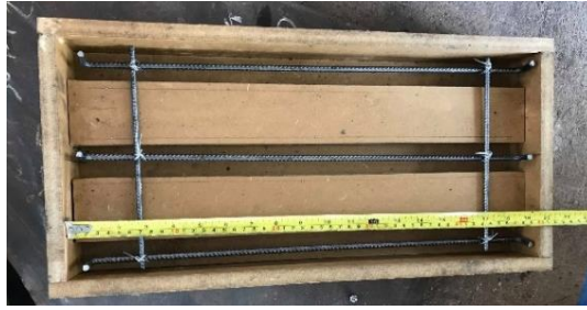
Figura 3-57 Armado de hierros losa unidireccional, espaciado longitudinal Fuente: Autores
