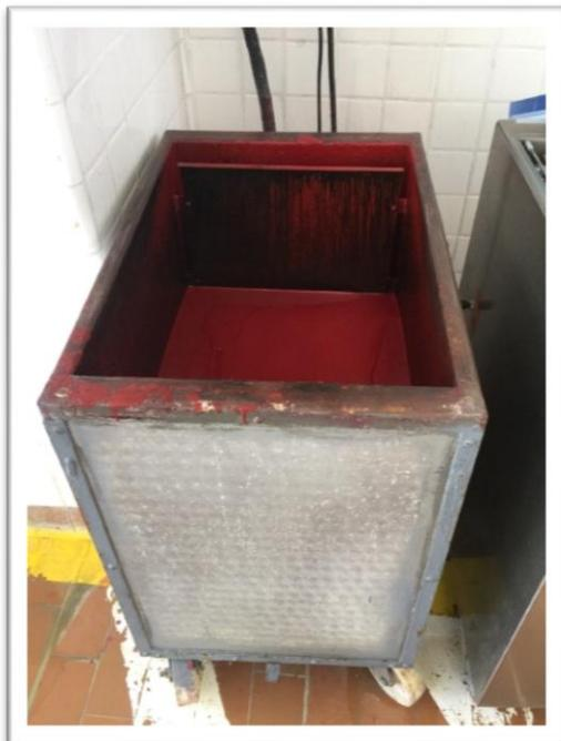
**Olla para pasteurización de la mezcla para helado**
