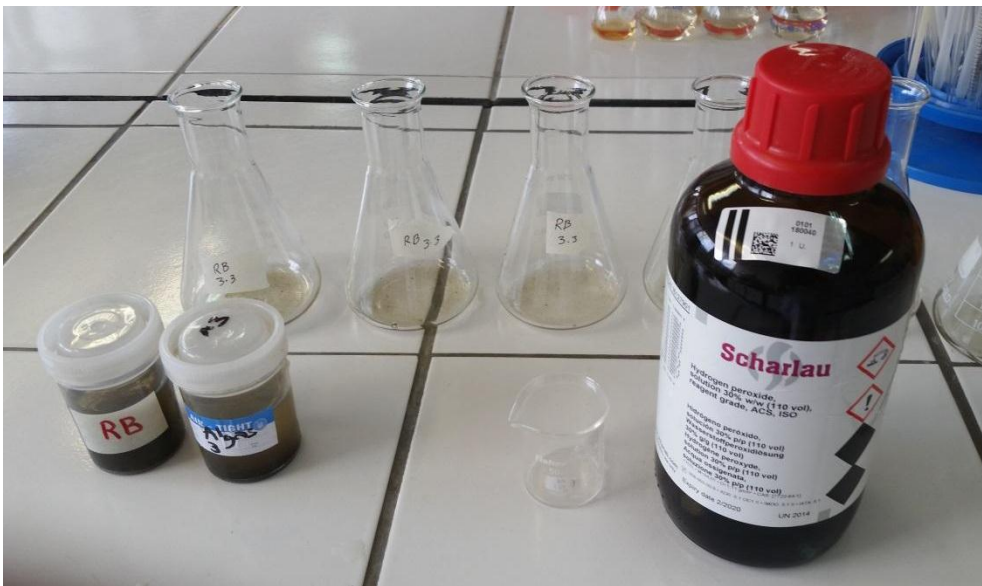
Ilustración 7. Limpieza de las microalgas con peróxido de hidrógeno
