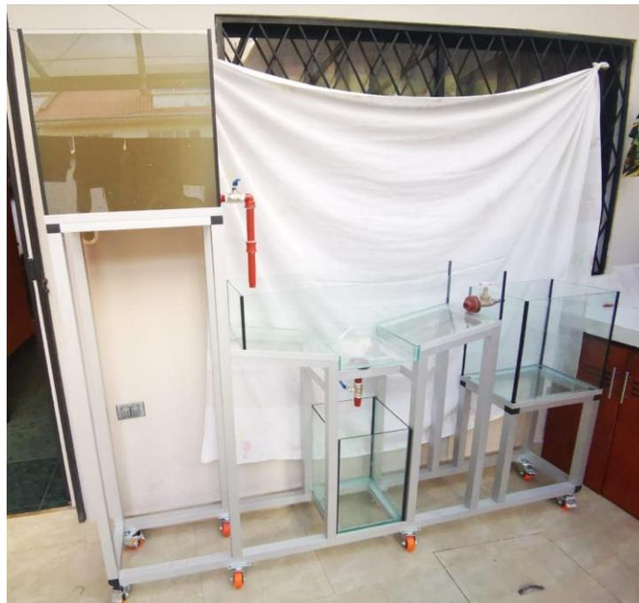
Figura 3.13. Tanque de entrada con el agua sintética.
