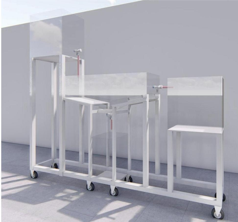
Figura 3.1. Sedimentador.
