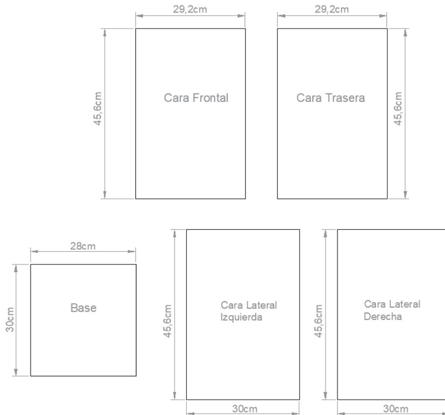
Figura 2.12. Secciones del tanque de almacenamiento de sedimentos.
