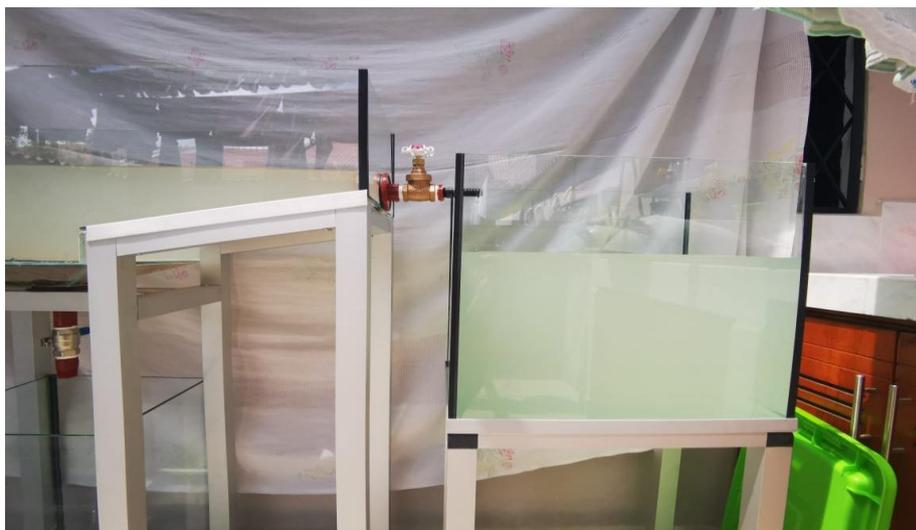
Figura 3.16. Tanque de salida agua clarificada.
