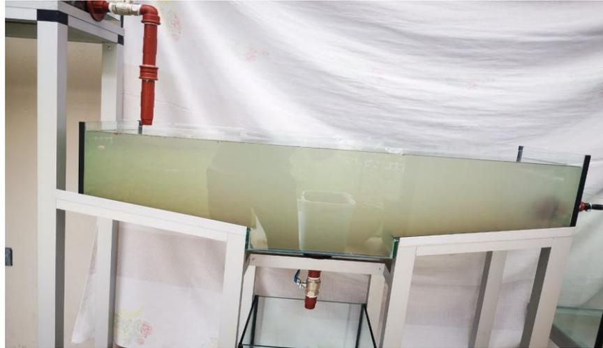
Figura 3.15. Sedimentador después de 12 horas de tiempo de retención.
