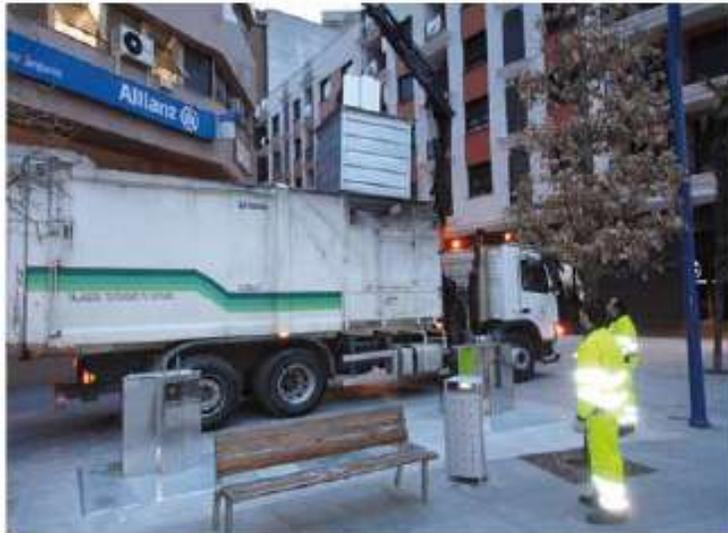
Figura 5.3 Vehículo empleado para contenedores soterrados tipo grúa.
