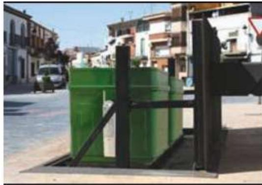
Figura 5.4 Contenedores soterrados de carga vertical.
