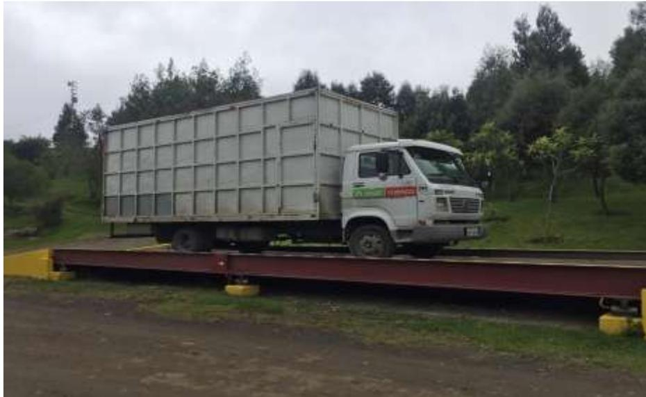
Figura 3.10 Pesaje del vehículo recolector.
