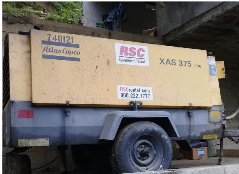
Figura I.14 Compresor utilizado en la mina.
