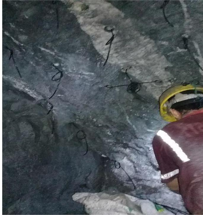
Figura III.4 Preparación de Voladura
