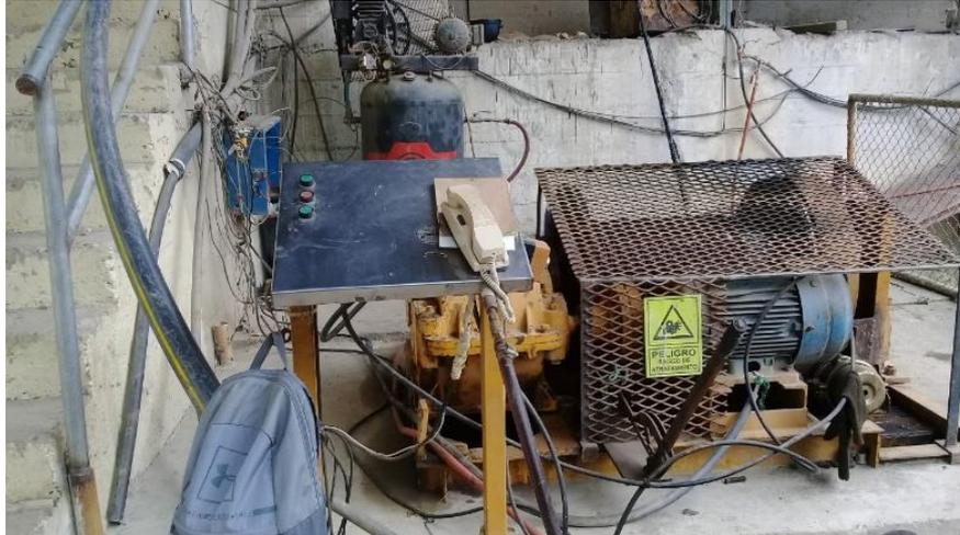
Figura I.13 Winche utilizado interior mina.
