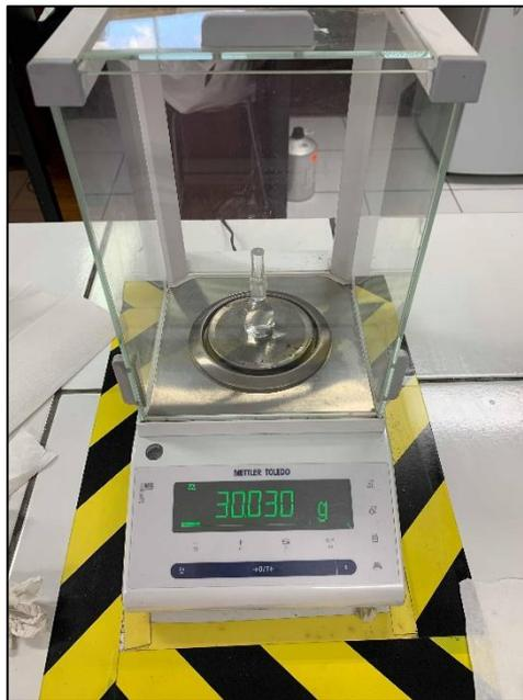
Figura 2. 5: Peso del picnómetro con roca de caja.
