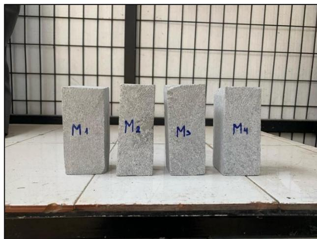
Figura 2. 6: Testigos de Roca para ensayo de la Resistencia a la Compresión Simple.
