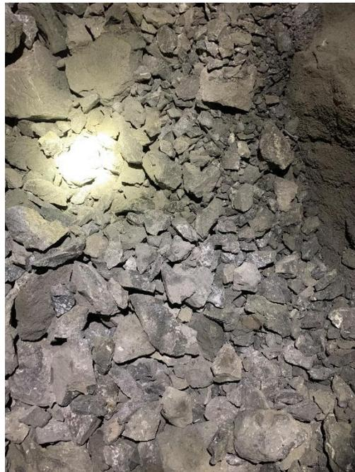
Figura 3. 10: Roca fragmentada después de la voladura del frente de explotación Nivel H.
