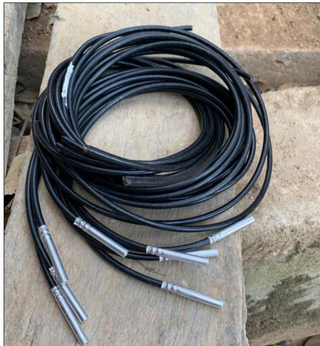
Figura 2. 16: Sistema de iniciación: fulminante ordinario y mecha de seguridad.
