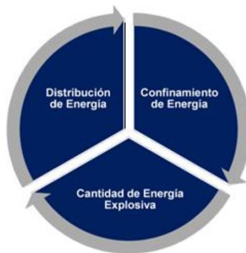
Figura 1. 25: Parámetros que afectan al rendimiento de una voladura.
