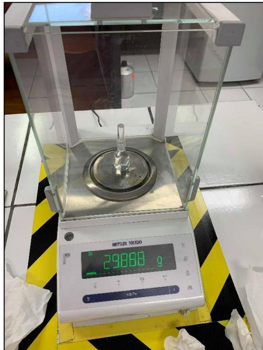
Figura 2. 4: Peso del picnómetro con agua.
