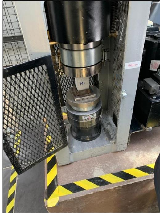
Figura 2. 7: Colocación del testigo en la prensa hidráulica para ensayo.
