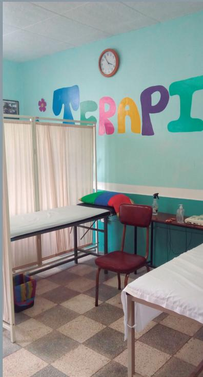
F5. El revestimiento de piso es de baldosa de granito y está deteriorada, el cielo raso es de estuco de yeso bajo relieve, paredes enlucidas y pintadas, el mobiliario existente no es ergonómico, por lo que deberá ser renovado.
