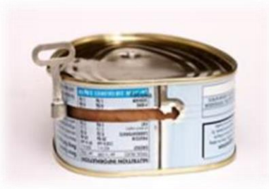
Ilustración 18: Enlatado con abolladura
