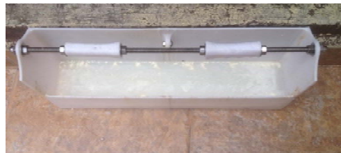
Figura 3-12 Remoción del depósito de recolección
