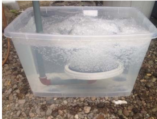
Figura 2-2 Funcionamiento de difusor con compresor de 2Hp.
