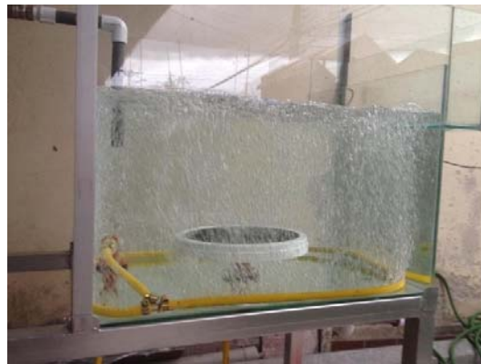
Figura 2-81 Manguera perforada manualmente sometida a prueba de aireación.
