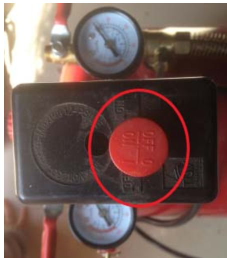
Figura 3-41 Botón encendido y apagado del compresor
