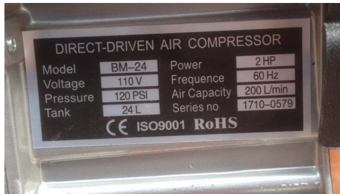
Figura 2-44 Especificaciones técnicas del compresor.
