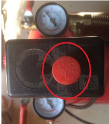
Figura 3-38 Botón encendido y apagado del compresor
