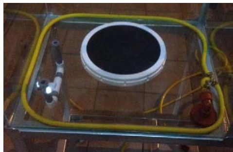
Figura 2-46 Manguera de gas perforada rodeando la parte interna del tanque.
