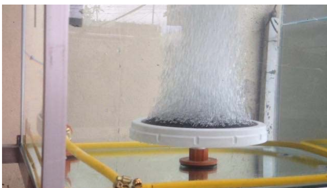
Figura 2-80 Difusor sometido a prueba de aireación.
