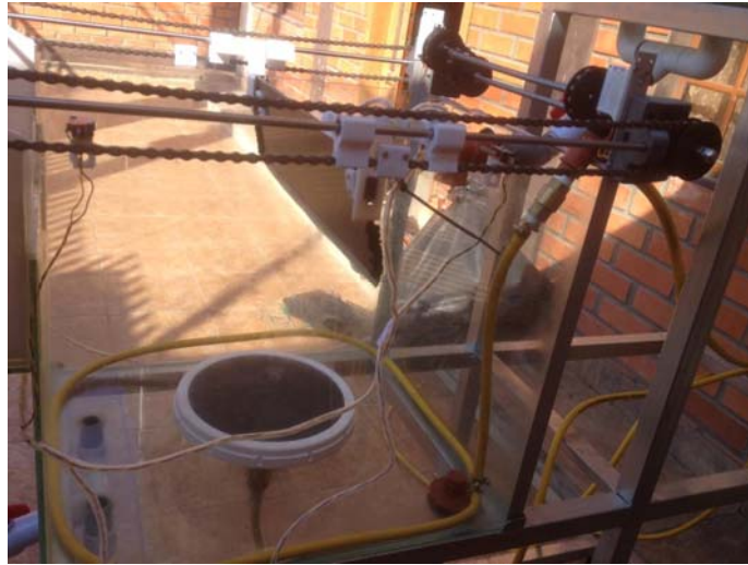
Figura 2-49 Sistema de aireación.
