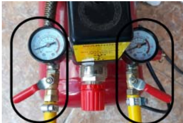
Figura 3-39 Manómetro izquierdo difusor de aire y manómetro derecho manguera de aire
