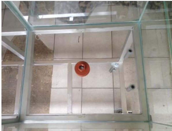
Figura 2-18 Perforaciones en la base del tanque con tuberías y acoples instalados.
