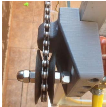
Figura 2-63 Cadena encaminada en el piñón y sus respectivas guías.
