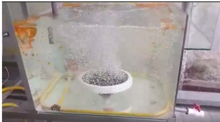
Figura 2-83 Prueba de separación de grasas y aceites.
