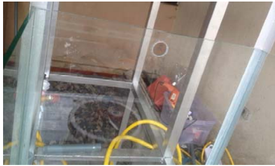
Figura 2-17 Perforación de 1" de diámetro en cara lateral del tanque.
