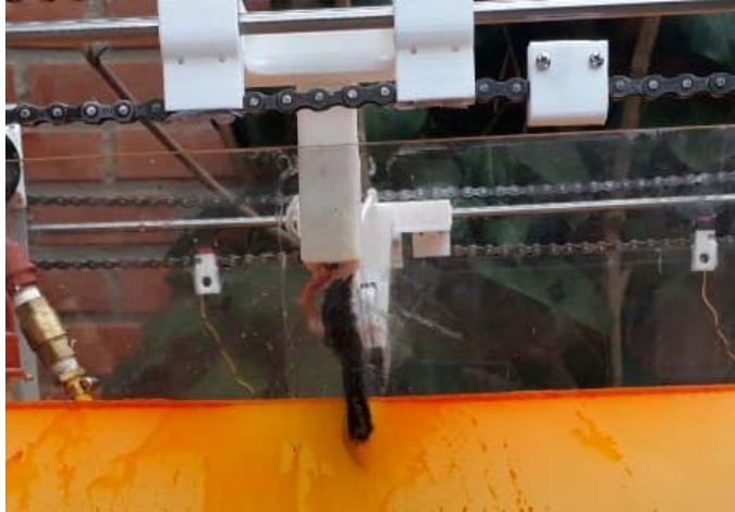
Figura 3-47 Limpieza con pala eléctrica
