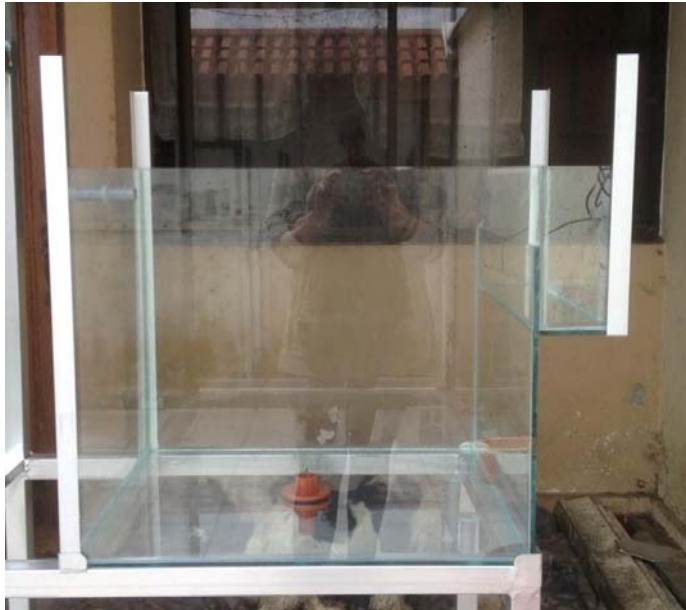
Figura 2-21 Tanque de flotación-aireación.
