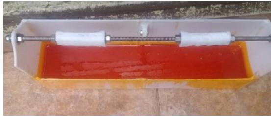
Figura 3-25 Remoción del depósito de recolección
