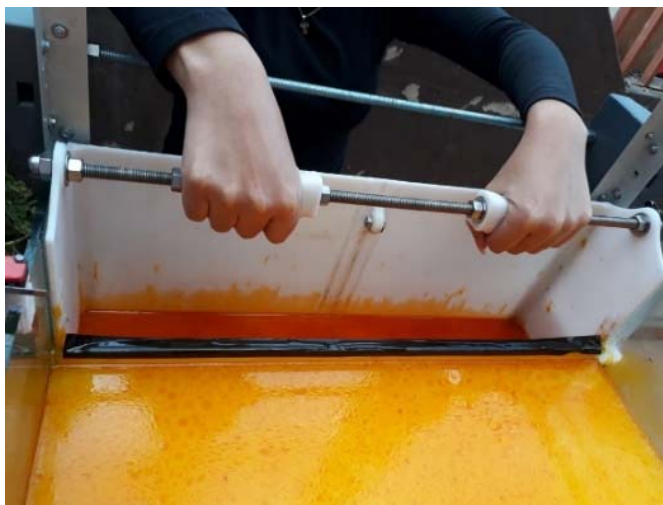
Figura 3-53 Remoción del depósito de recolección
