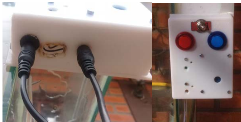
Figura 2-79 Conexiones de las fuentes de poder y caja principal de mandos.
