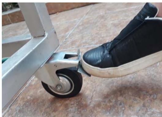
Figura 3-27 Inmovilización de la estructura metálica
