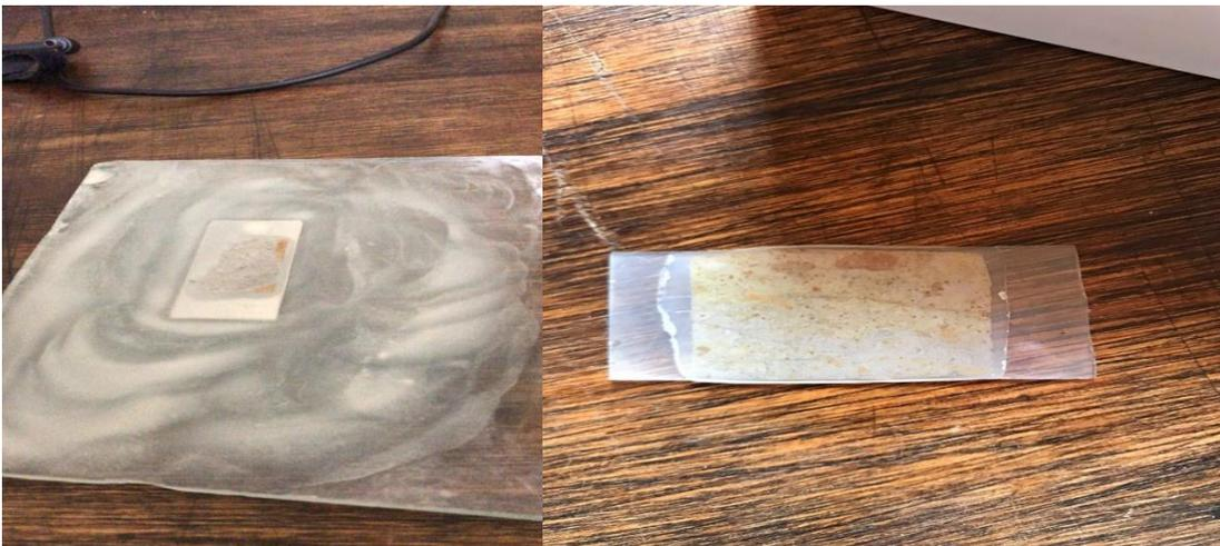
**Figura 3.5:** Lámina delgada con un espesor aproximado de 30 micras.
