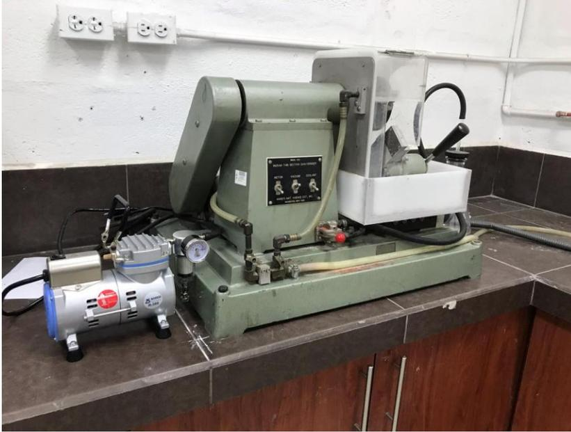
**Figura 3.4:** Máquina para el corte secundario de la briqueta.
