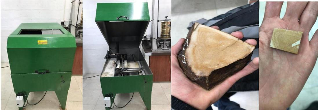
**Figura 3.3:** Corte primario de la roca.
