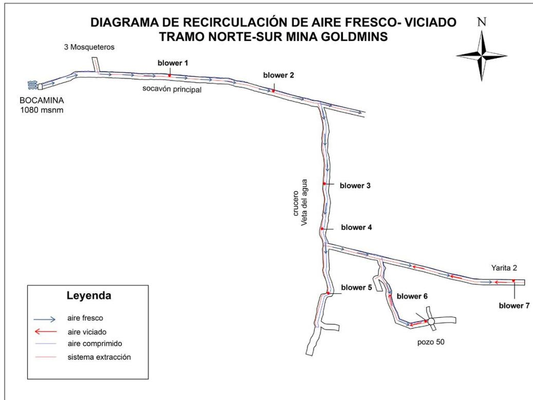
Figura 2.7. Recirculación de aire fresco-viciado en la mina Goldmins.
