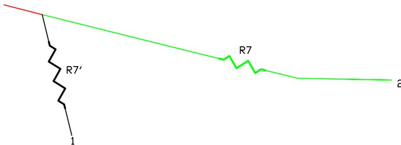
Figura 2.28. Esquema (R7, R7') en paralelo.
