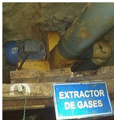
Figura 3.8. Motor W22 Ventilación 200°- 2h-IE1-Trifásico, 20 HP
