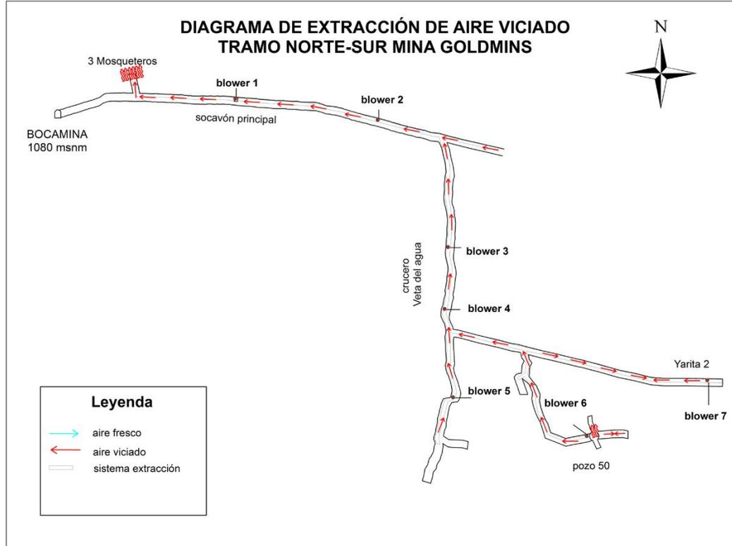
Figura 2.6. Salida de aire viciado en la mina Goldmins.
