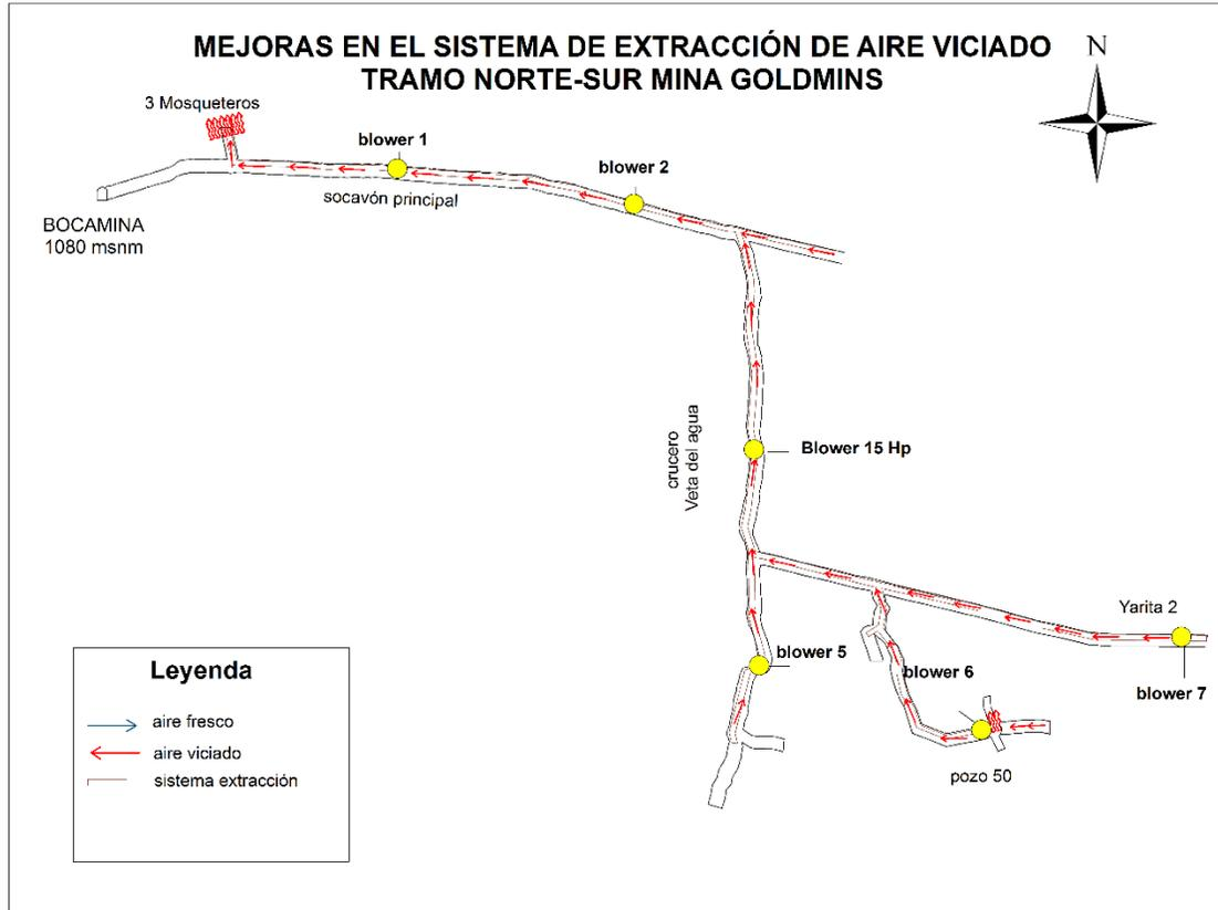
Figura 3.1. Esquema de mejoras en el sistema de extracción de aire viciado tramo norte-sur, mina Goldmins
