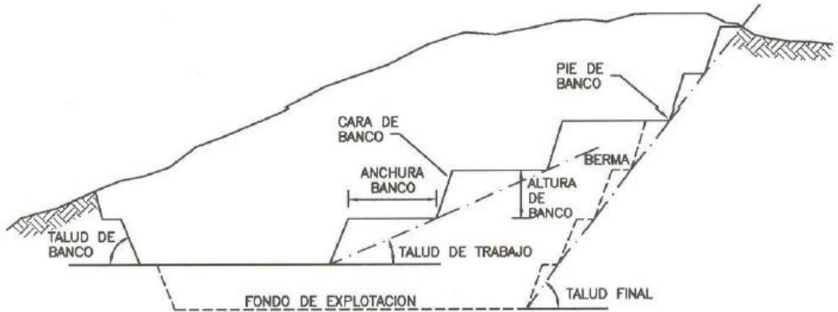
Figura 2.6 Terminología empleada en una mina a cielo abierto.
