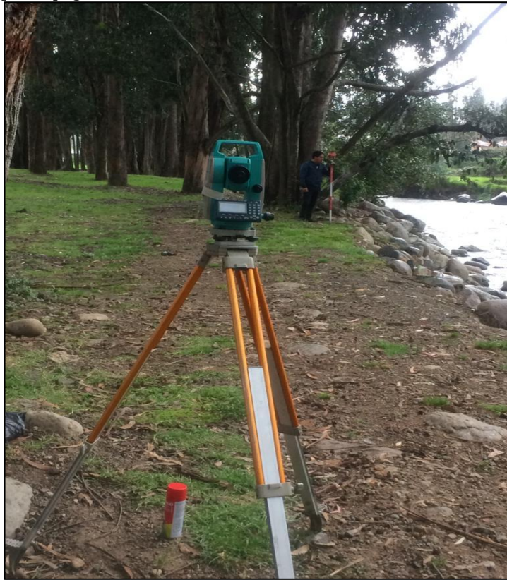
Figura 2.20: Levantamiento de información con Estación total Tramo Misicata – Av. de las Américas Fuente: Autor
