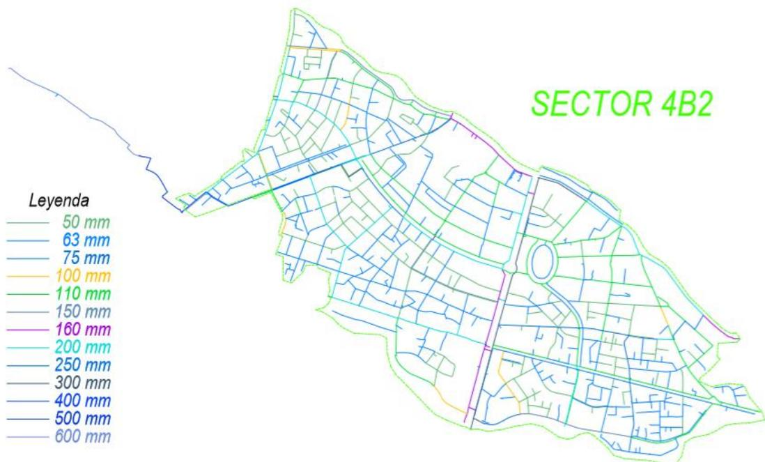
Figura 1.7 Catastro año 2015 de la red de distribución de agua potable sector 4B2
