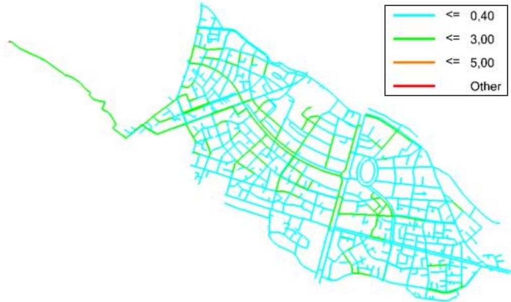
Figura 3.5 Velocidades clasificadas por color del sector 4B2 implementada la sectorización
