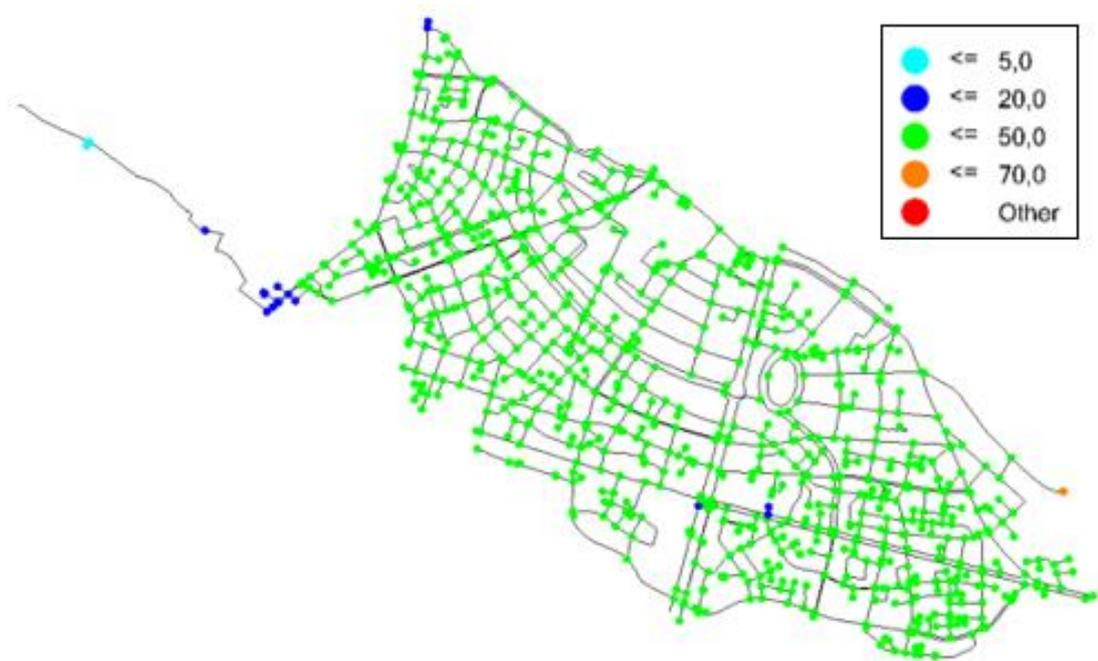
Figura 3.9 Presiones de carga clasificadas por color del sector 4B2 implementada la sectorización
