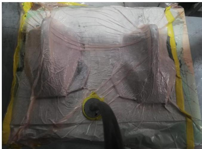
**Fig. 13.** Moldes empaçados al vacío.
