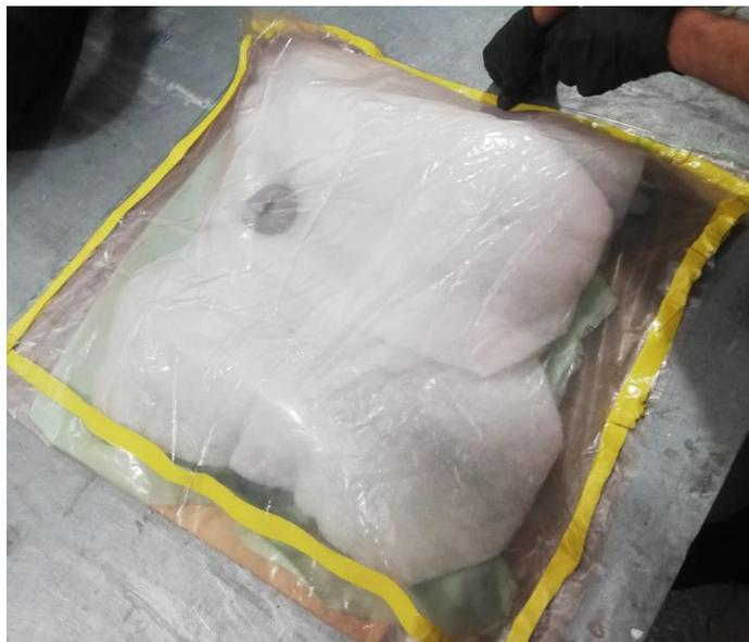
**Fig. 12.** Empaque para vaciado.
