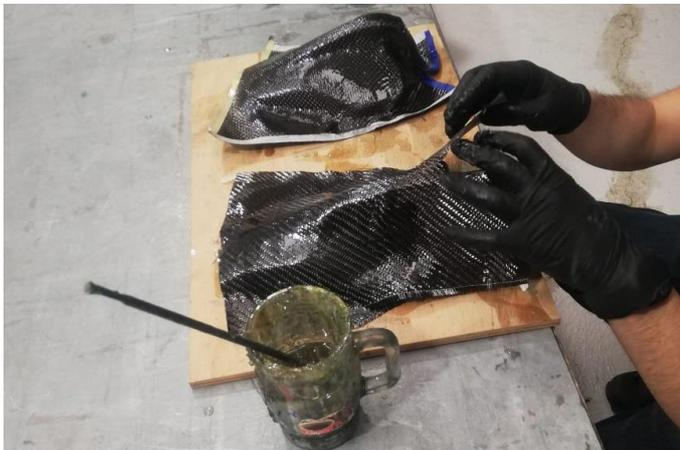
**Fig. 10.** Aplicación de capas de resina y fibra de carbono.
