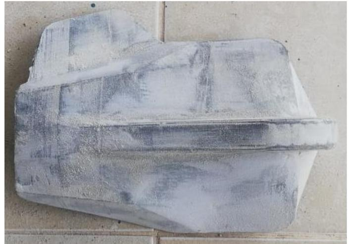
Fig. 7. Masillado de la impresión.
