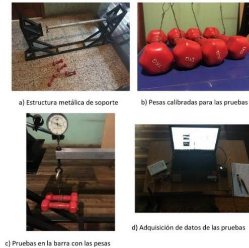
Figura 8. Pruebas de flexión en el perfil.
