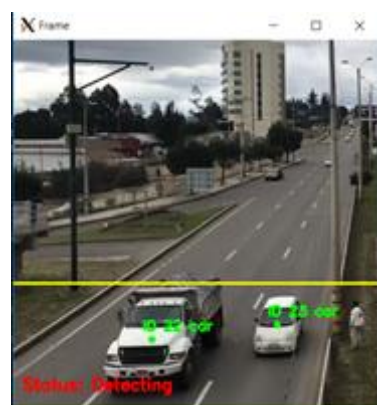
Figura 11: Imagen aplicando SSD donde que se detecta al camión como un carro.
