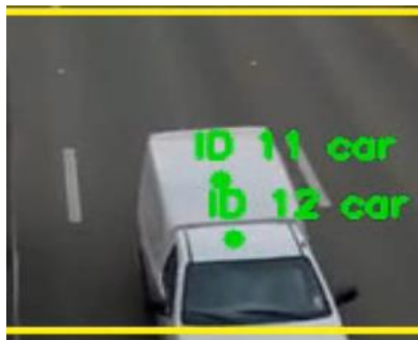
Figura 18: Ejemplo de conteo doble. En algunos casos como el que se observa en la figura los vehículos con parrillas especiales son detectados como dos vehículos.
