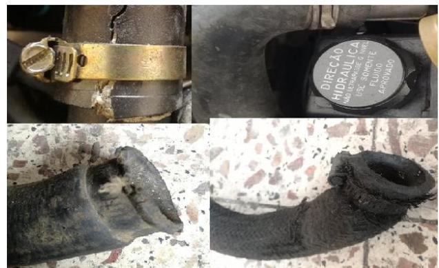
Foto. 1. Fotografías de mangueras rotas y/o deformadas.
