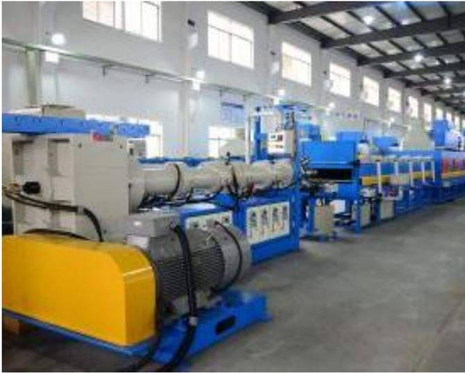
**Fig. 6.** Línea de producción de mangueras.
