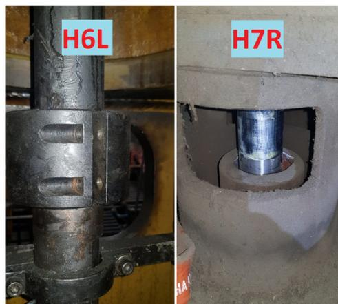
Figura 9. Daños en Cilindros
