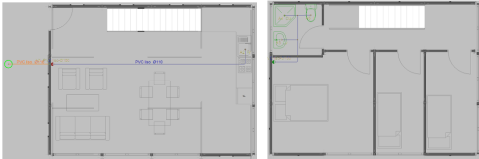
Figura 4.7. Conexión de saneamiento planta baja y alta de la vivienda de 2 plantas, vista 2D Fuente: CYPE 2017
