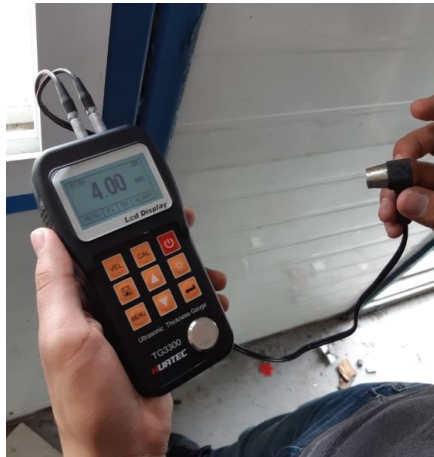
Figura 2.1. Equipo de ensayo END (Ensayo no destructivo) Fuente: Autores
