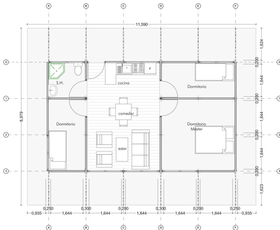
Figura 2.5. Plano arquitectónico de la vivienda de 1 planta
