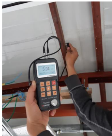
Figura 2.4. Medición del espesor de las correas con el equipo de END Fuente: Autores
