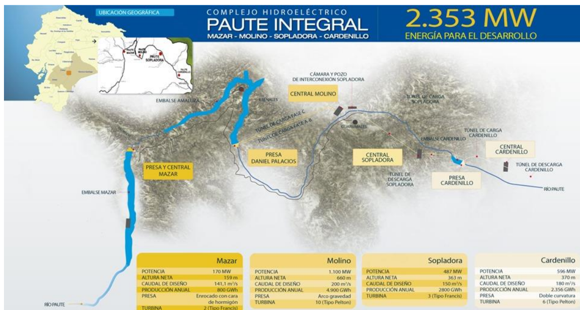
Figura 1.1. Aprovechamiento hidroeléctrico Paute Integral, actualmente implementado el 75% de la potencia total instalada de 2353 MW, la cual se completará con la construcción de Paute Cardenillo (593 MW).
