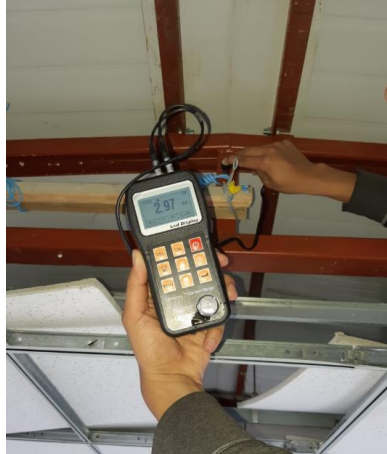
Figura 2.3. Medición del espesor de la celosía triangular con el equipo END Fuente: Autores
