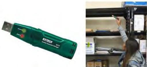
Imagen 23: Ubicación de equipo Datalogger para toma de temperatura del aire y humedad relativa en oficinas de Control Urbano y Gestión Financiera. Fuente: Autoras, 2020
