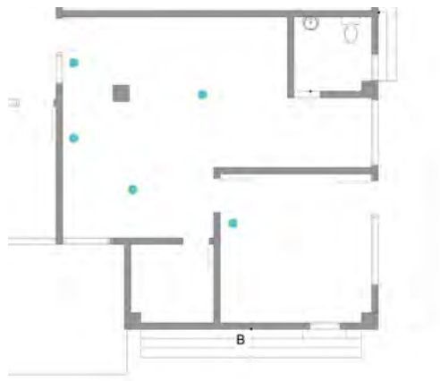
Imagen 26: Esquema de colocación de equipos de temperatura ambiente y humedad relativa en oficina de Gestión Financiera. Fuente: Autoras, 2020.
