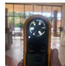
Imagen 22: Toma de la velocidad del viento en accesos de la edificación. Fuente: Autoras, 2020
