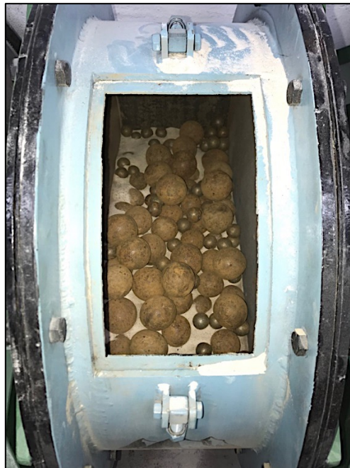
Gráfico 28. Carga de bolas molino SAG de laboratorio
