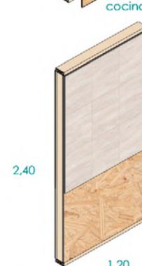
85. Paneles tipo - Axonometría
