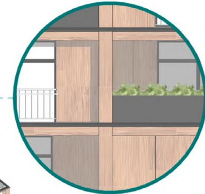
El proyecto se construye a base de elementos de madera aserrada y prefabricada, conformando módulos flexibles que proporcionan variación en la fachada.
