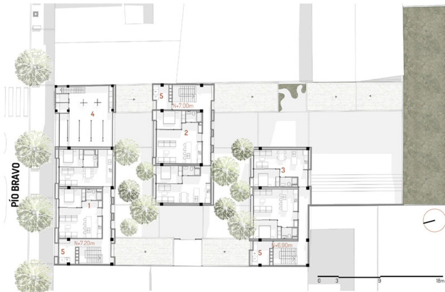
FIG 64 PLANTA ALTA 2 ZONA B. FUENTE: ELABORACIÓN PROPIA
