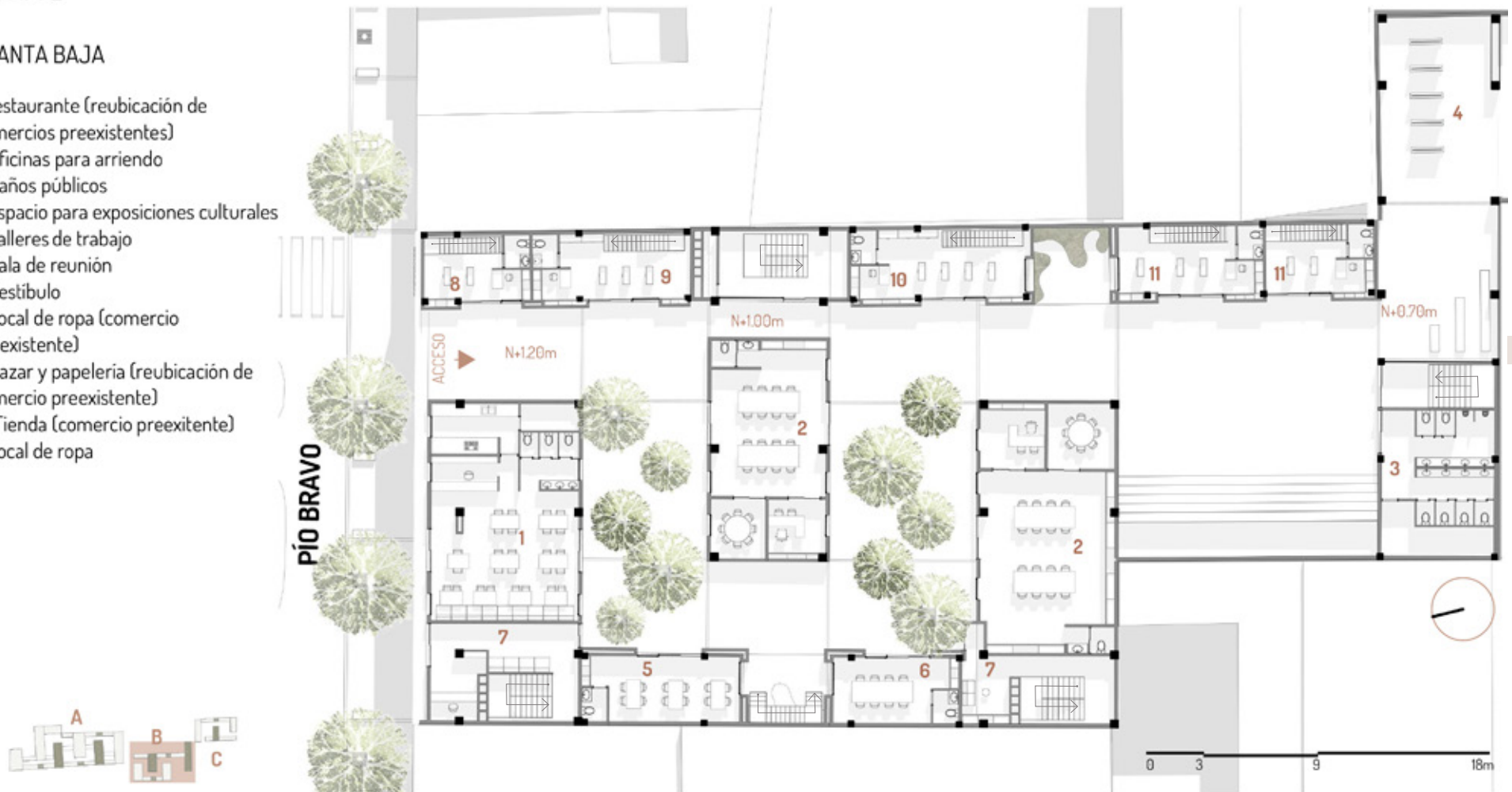
FIG 62 PLANTA BAJA ZONA B. FUENTE: ELABORACIÓN PROPIA
