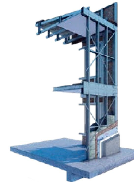
El sistema Steel Frame es un conjunto de perfiles colocados en ambos sentidos formando los muros, forjado a través de la colocación a una distancia dada (por cálculo estructural) de perfiles de acero galvanizado hasta conformar cada elemento de la estructura de la edificación (Pérez, 2013). (Ver en Imagen 9)
