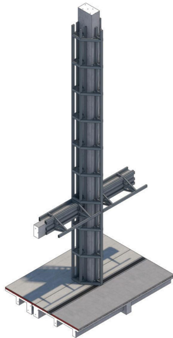
2.- Armado de exo-estructura de tubería metálica de soporte de porcelanato con la forma deseada.
