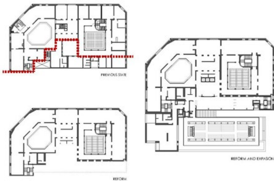
Imagen 33. Esquema de intervención. IMB Arquitectos.
