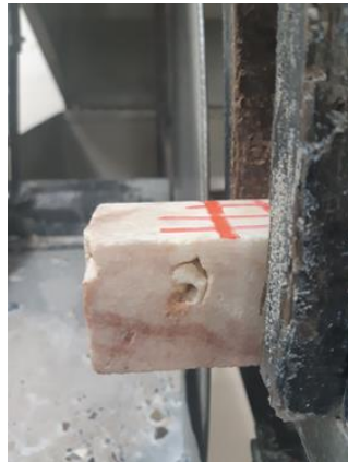
Figura 2.14 Colocación de la probeta de tal manera que la línea quede en frente del disco
