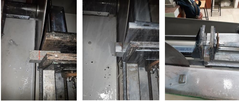
Figura 2.15 Proceso del segundo corte de la probeta
