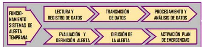
Fig. 15 Esquema de funcionamiento de un SAT. [9].
