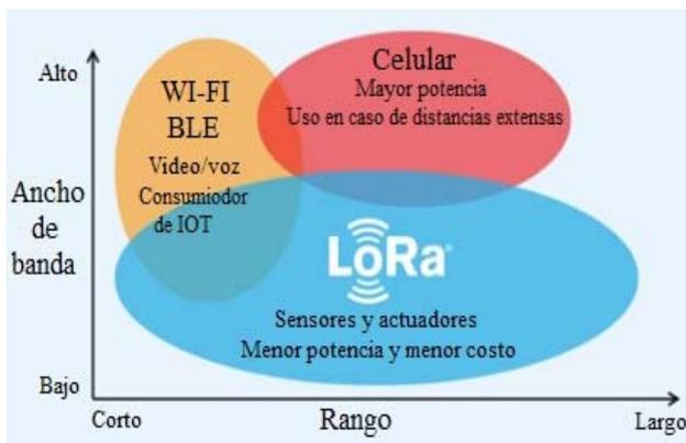
Fig. 11 Rango Protocolo LoRa.
